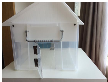
圖 6 排煙模擬示意圖(改變開口位置)
