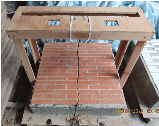
圖 5 試體與紅外線支架照片
