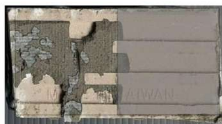
圖 3 不灑水 50%-3 磁磚斷裂位置面積圖
