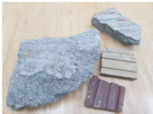
圖 1. 各式外牆瓷磚剝落樣態
