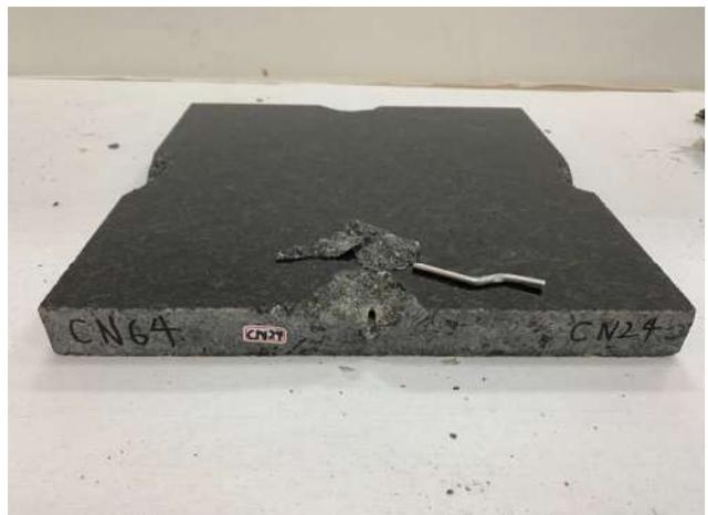
圖 8. 6.5cm 插銷無添加 AB 膠之石材破壞樣態
