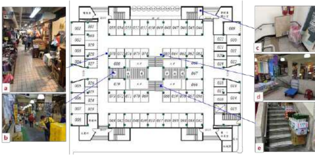
圖 6 市場障礙物影響情況 (e 攤架至於通行廊道、b 斜坡道堆放物品、c 樓梯通道堆放物品、d 樓梯出口走道堆放籃架、e 樓梯堆置物品、)
