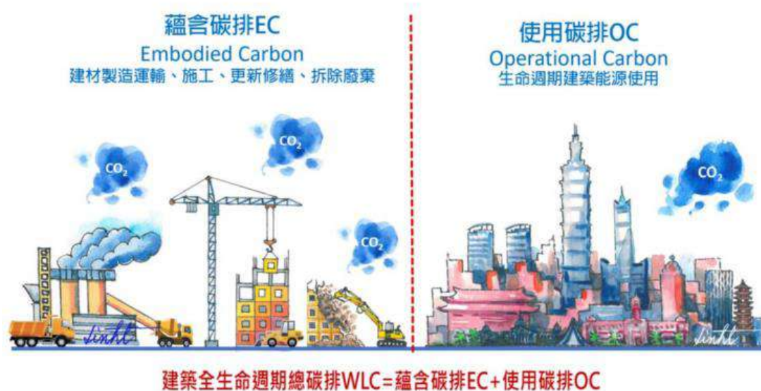
圖 3 建築物全生命週期碳足跡蘊含碳排 EC 與使用碳排 OC(2022,林憲德)
